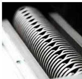
Cilindri di taglio con tempratura speciale per tagli di precisione.
